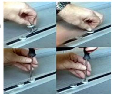
Die Rändelmutter dient nur als Montagehilfe und muss wieder abgeschraubt werden! In diesem Film wird das Einsetzen gezeigt: <https://youtu.be/CCat94xLoEo>
