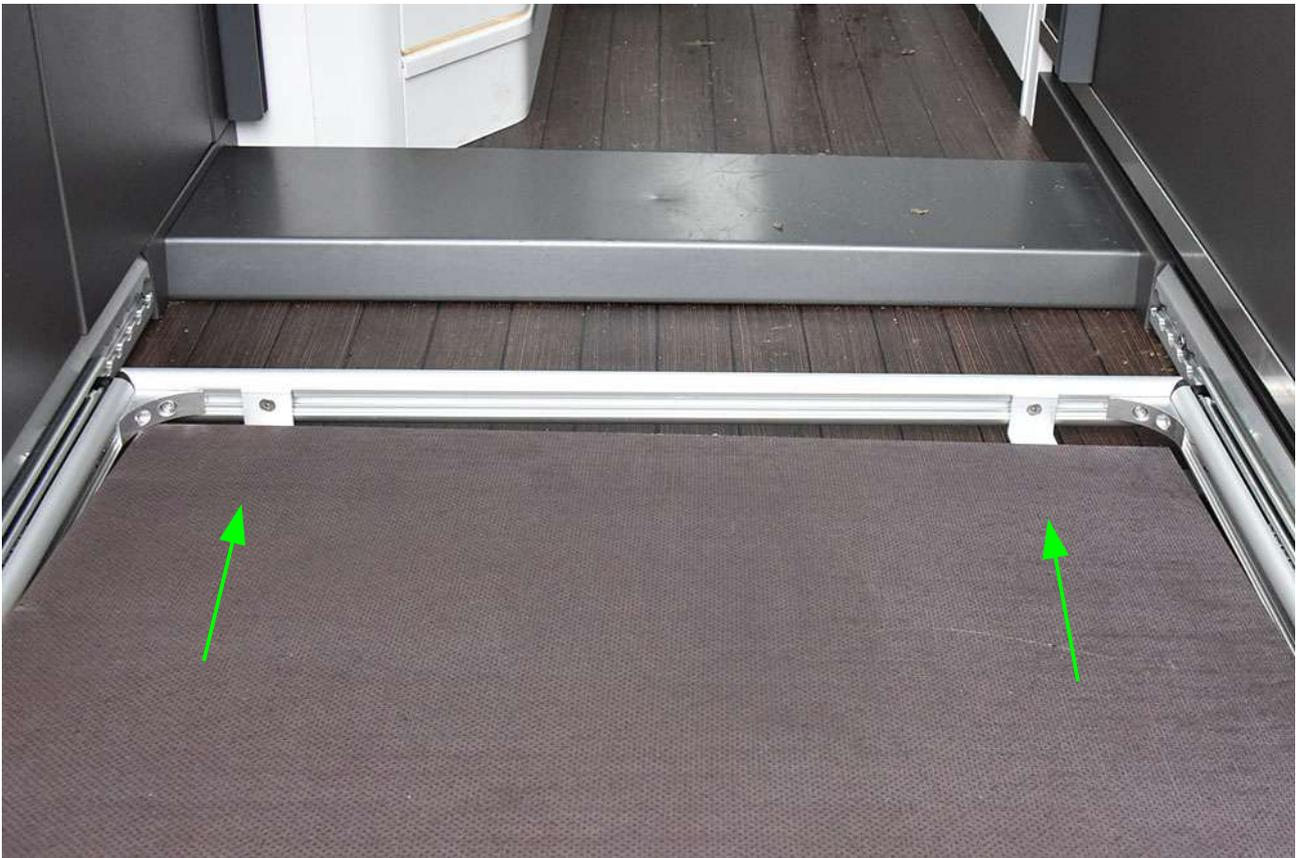
Auch die hintere Profilschiene muss wieder ohne verkanten parallel auf das Längsprofil geschoben werden.
