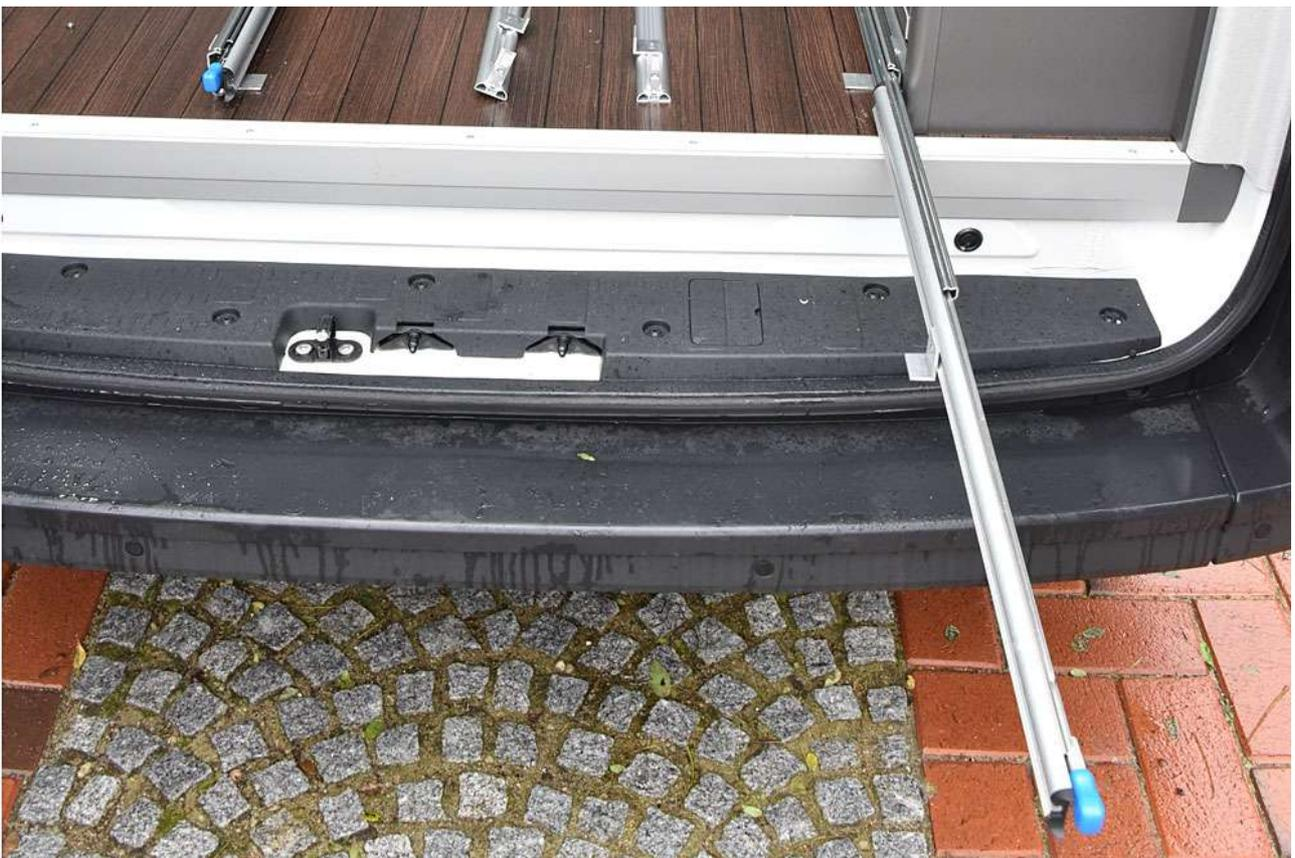
Um die Bodenplatte einzulegen musst du das hintere Querprofil etwas nach hinten verschieben. Die Bodenplatte wird zuerst vorne zwischen Haltewinkel und Verbindungswinkel geschoben. Danach schiebst du das hintere Querprofil parallel ein. Dies geht nur bis 9 mm Dicke. Bei dickeren Platten musst du die Ecken abrunden. Als Kreisschablone sind die Eckverbinder gut geeignet.
