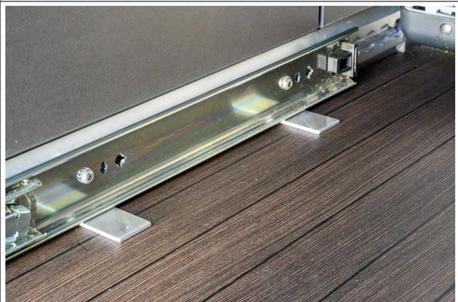
Diese Abbildung zeigt die linke Teleskopschiene mit 80 cm Tiefe. Durch leichtes Lösen der Schrauben lassen sich die beiden Teleskopschienen noch um ca. 1-2 mm verschieben um sie optimal auszurichten.
