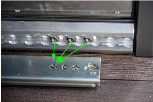
Die Airlinemutter werden zunächst in der rechten Airlineschiene eingesetzt. Sie können individuell positioniert werden. Wenn euer Fahrzeug über den optionalen Außentisch und die beiden Stühle verfügt, sollte noch genug Platz dafür eingeplant werden.
