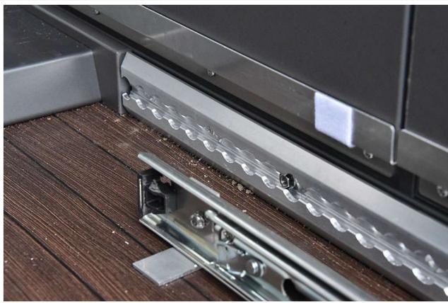
Die Teleskopschiene wird zusammen mit den Stützwinkeln lose an die Airlineschiene geschraubt. Dadurch bleibt sie noch etwas verschiebbar um die zweite Schraube leichter anzubringen.
