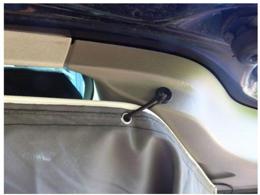
Die Originalstopfen müssen durch die Schlaufenstopfen ersetzt werden. Möchten Sie das nicht, können alternativ die Saugnäpfe verwendet werden. Der Speedclip muss sich innerhalb befinden, um ein evtl. Einklemmen beim Schließen der Heckklappe zu vermeiden.
