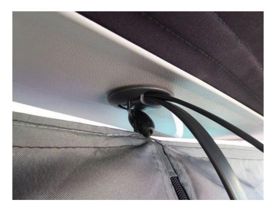
Der Kabelbinder wird durch die Achse der Halteschlaufe gefädelt und hält das Heckzelt in der Mitte.
