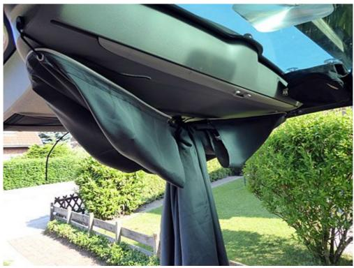
Vor dem Schließen der Heckklappe wird das gereffte Heckzelt mit einem Speedgummi ebenfalls am Kabelbinder an der Schlaufe befestigt. Die Enden können auch an der Kederschiene befestigt bleiben.
