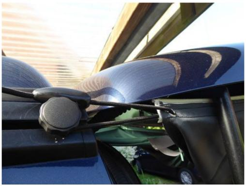
Bei der Befestigung an der Kederschiene ist darauf zu achten, dass der Speedclip sich außerhalb der Heckklappe befindet, um Beschädigungen zu vermeiden, wenn die Heckklappe geschlossen wird.
