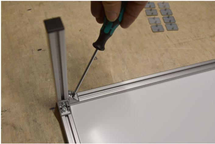
Zum Schluss alle Schrauben kräftig nachziehen und die Abdeckkappen der Verbindungswinkel einsetzen.
