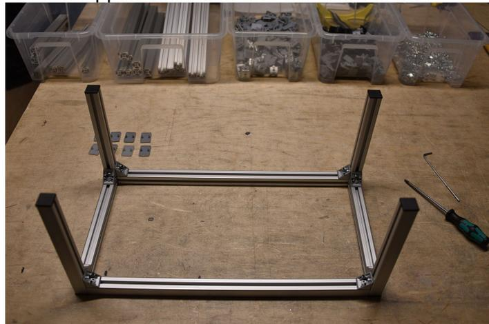
Vor dem Zusammenschrauben muss in jedes Längsprofil eine Mutter lose eingelegt werden. Diese ist nötig, damit später bei Bedarf das Verstärkungsprofil festgeschraubt werden kann. Mit dem Verstärkungsprofil wird die Platte trittfest.
