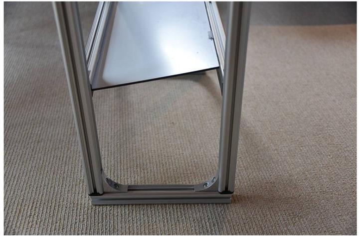
Unteren Einlegeboden einsetzen und beide Seitenrahmen zusammenschieben.
