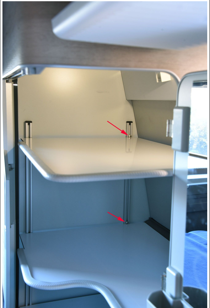
Zum Schluss müssen noch die 6 (4) langen Stützschrauben positioniert und festgeschraubt werden.
