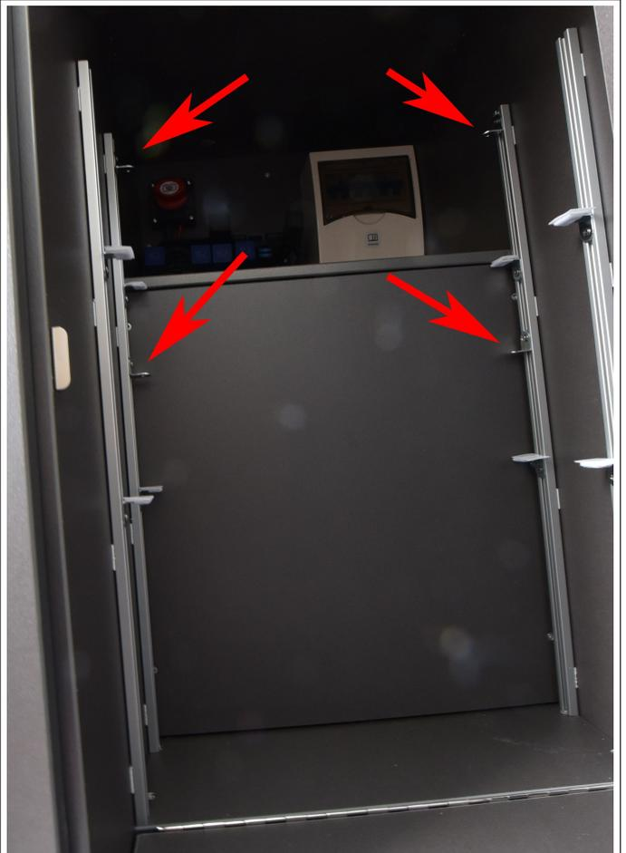
Beim kleinen Schrank ragen die Einlegeböden über die inneren Stützwinkel hinaus. Damit sie halten, müssen sie jeweils vorne und hinten am Außenprofil oberhalb der Böden mit Stützwinkeln fixiert werden. Diese solltest du schon vorher provisorisch oberhalb der Einlegeböden festschrauben.
