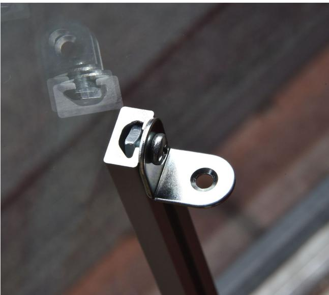
Setze die Winkel mit den Schrauben und Vierkantmuttern ein.
