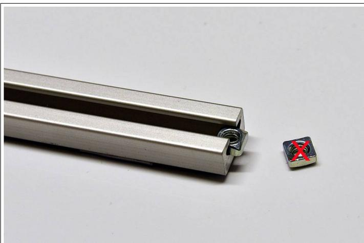
Die Muttern müssen mit der abgerundeten Seite nach oben eingesetzt werden.
