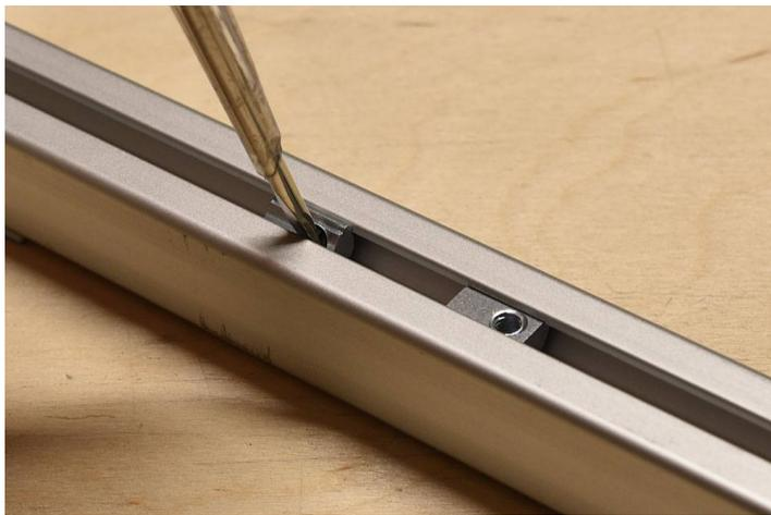
Einsetzen der Kedersteine in die Trägerprofile.
