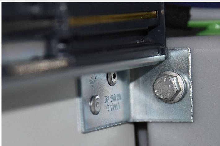
Die Schiene kann nur oberhalb (empfohlen) oder unterhalb der Schraube des Abwassertanks befestigt werden.
