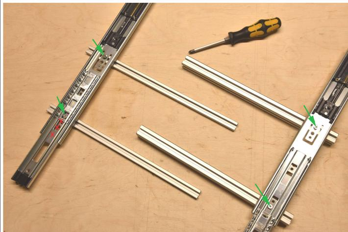
Alle Profile werden mit Kedersteinen und Schrauben in den Langlöchern befestigt, außer links vorne, dort ist es das 4. Loch.
