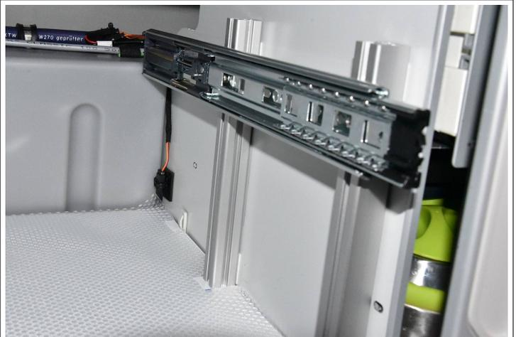
Rechts muss am Abwassertank ein Abstand von ca. 2 mm gelassen werden (entsprechend dem Haltewinkel links). Der Kugelkäfig muss ganz nach hinten geschoben werden.
