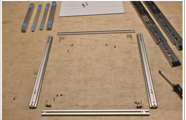
Setze die 8 Muttern für die Eckverbindung ein.
