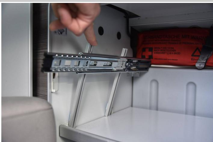
Die Teleskopschienen werden links und rechts hinten bündig mit dem Abwassertank am Schrank befestigt.
