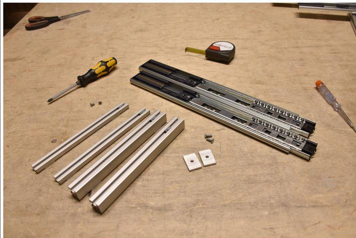
Die Distanzplatten für die Profile sind bei der linken Schublade nur für T5 und T6 nötig.
