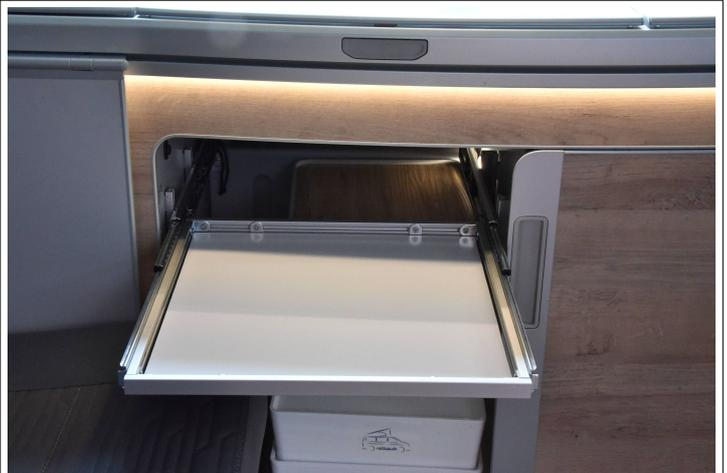
Sollte die Bewegung der Schublade etwas hakelig sein, kann man die Schrauben der Querprofile lösen und dadurch den Abstand in eingeschobener Position optimieren.
