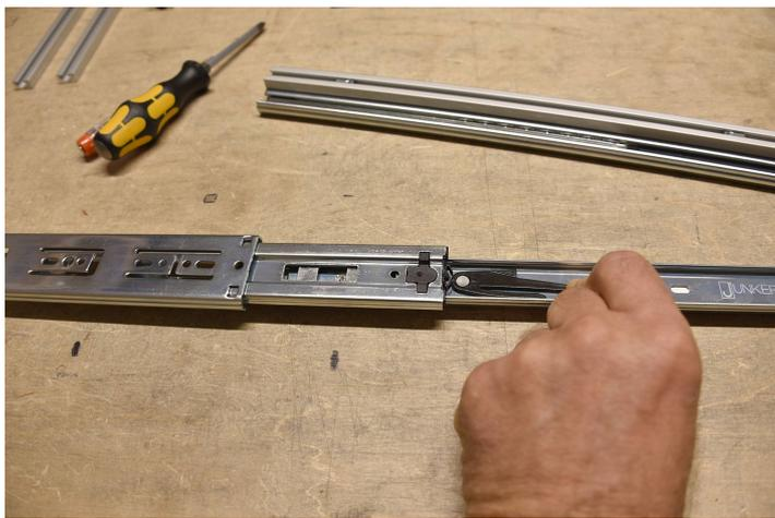
Entriegele die Teleskopschiene und ziehe das Profil heraus.
