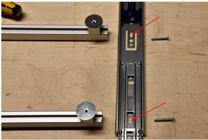
Alle Profile werden in den äußeren Langlöchern mit Kedersteinen im Profil befestigt.
