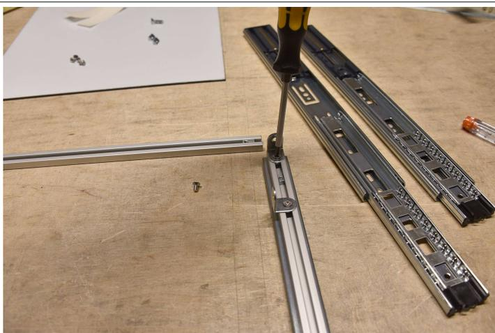
Befestige die 4 Eckwinkel an den beiden seitlichen Profilen.
