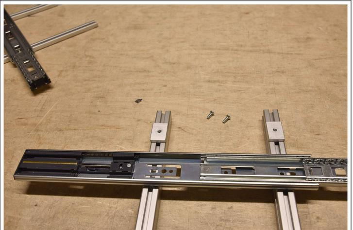
Beim T5 und T6 müssen Abstandsplatten eingebaut werden.
