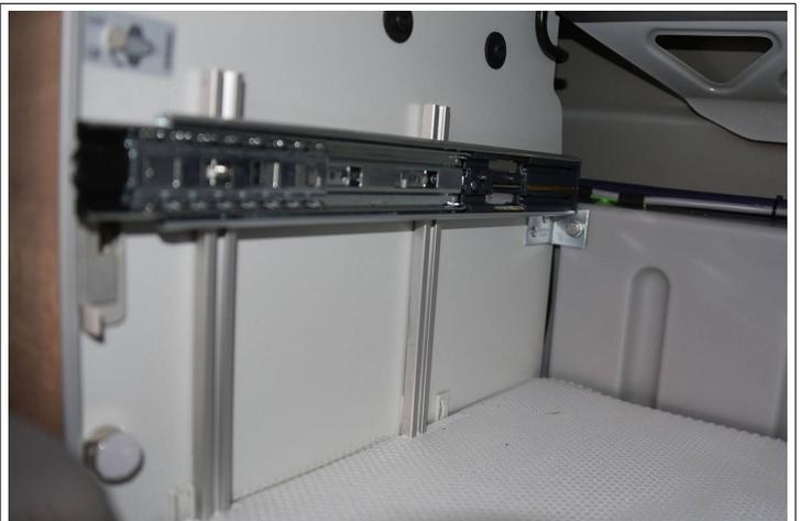
Dies sollte vorher mit vorhandener Schutzfolie ausprobiert werden. Ein Verschieben ist nach dem Kleben nicht mehr möglich
