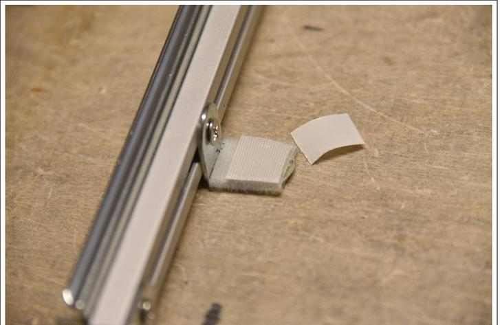
Klebe den Flauschstreifen auf die Winkel und hefte den Klettstreifen an. Die Folie sollte erst nach dem Einbau entfernt werden.
