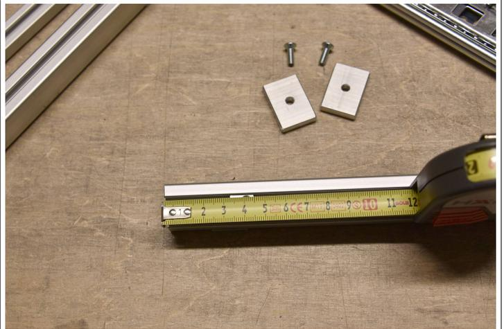
Der Abstand der Kedersteine beträgt 4,2 cm von oben. Die Position kann später im eingebauten Zustand, je nach Verwendungszweck, verändert werden.
