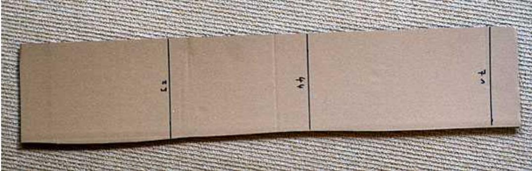
Fertigen Sie dazu zwei 15 cm breite Schablonen aus Pappe an, um links und rechts die gleiche Höhe und eine parallele Ausrichtung der Halterungen zu erhalten.
